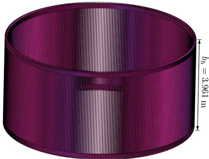
Figura 10 – Barras estáticas do hidrogerador e suas dimensões: (a) modelo da barra tipo bobina e (b) todas as 378 barras estáticas dispostas no modelo do hidrogerador. As dimensões  $b_w$  e  $b_h$  são fornecidas.
